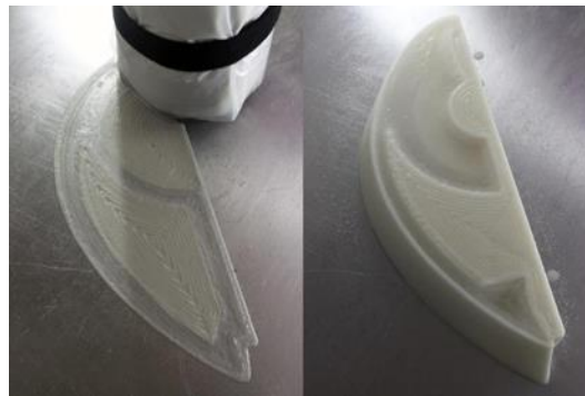
شکل ۱-۸. ساختار نهایی چاپ سه بعدی یخ پس از ذوب مواد تقویت کننده از نمک (۹)
