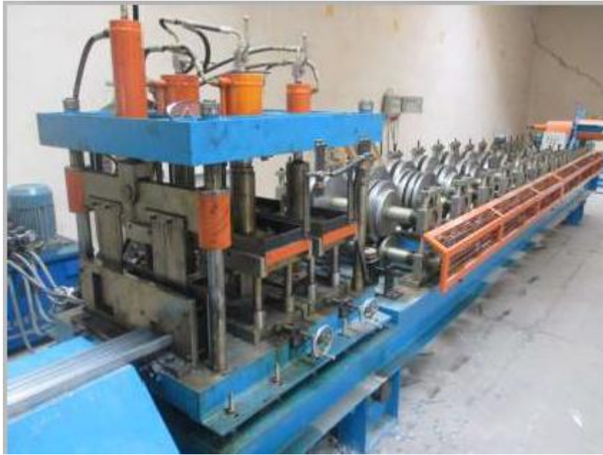
شکل ۲- نمونه‌ای دستگاه تولید ورق‌های LSF
