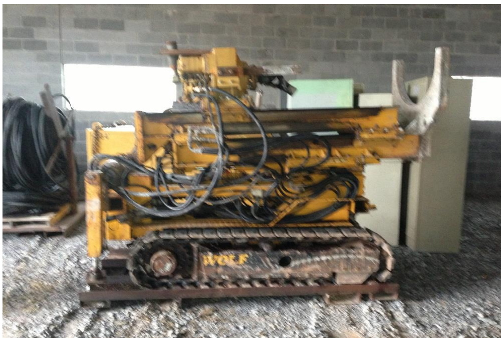
شکل ۶: تجهیز مناسب کوبش ریزشمع در فضاهای محدود
